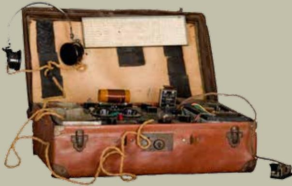
106 et 107. Poste émetteur-récepteur muni d'un casque (pour que l'opérateur puisse écouter le code afin de le retranscrire) et d'un émetteur d'impulsion (pour coder les messages). Un manuel d'instruction est joint au poste.
